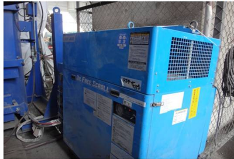
エアラインマスク用 コンプレッサー (オイルフリースクロール圧縮機)
